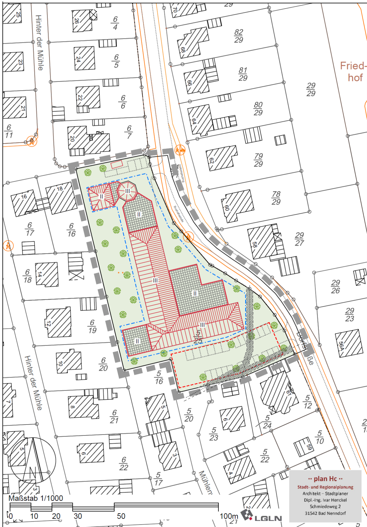
Zeichnung genordet, unmaßstäblich verkleinert, im Original Maßstab 1/1000 (mit ausgewählten Angaben aus dem B-Plan - Geschossigkeit, Baugrenzen, Stellplätze und Leitungsrecht)
