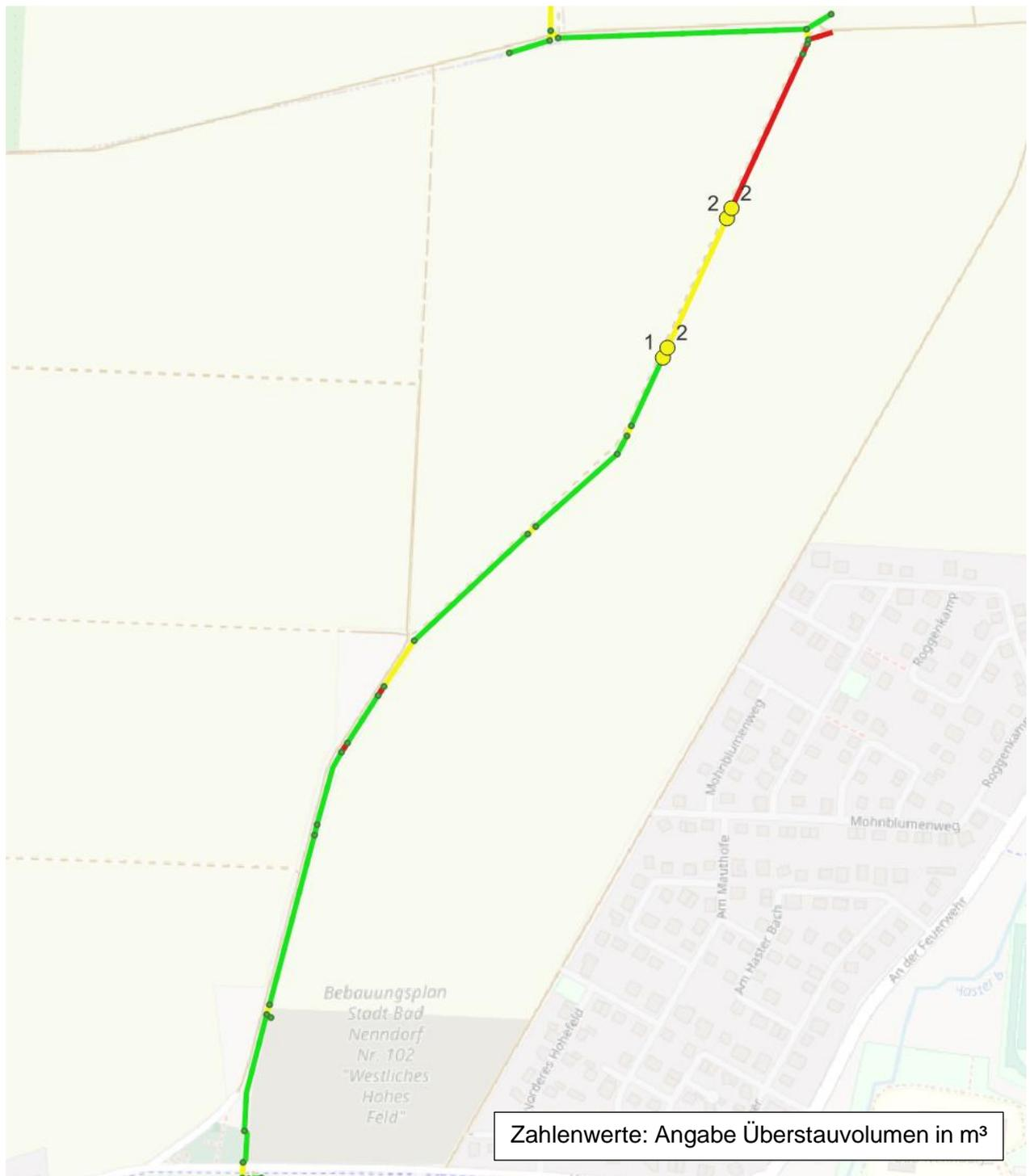
Abbildung 12: Auswertung Überflutungsprüfung T=50a, Auslastung und Überstau
